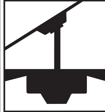
VAULTED CEILING INSTALLATION INSTALACIÓN PARA TECHO ABOVEDADOS
